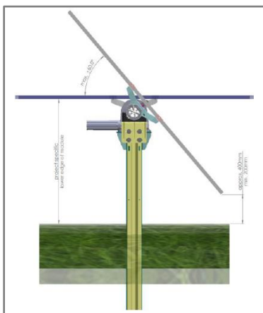
Abbildung J: Prinzipskizze Solartracker (Quelle: gp. Joule [7] / Zimmermann PV-Tracker GmbH)
