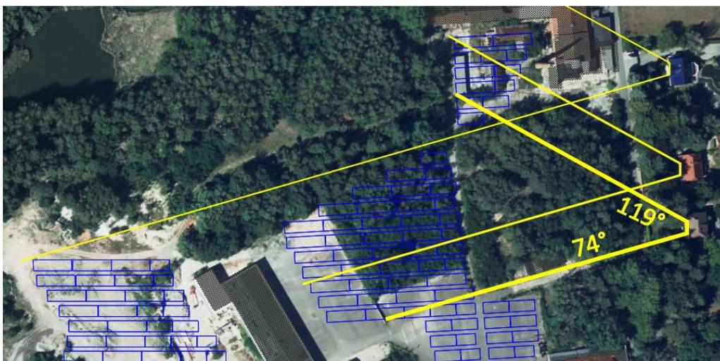
Abbildung 11: Azimutbereiche östlich zu den Wohnhäusern gerichteter Reflexionen mit Winkeln zwischen  $74^\circ$  und  $119^\circ$  durch gelbe Linien abgegrenzt
