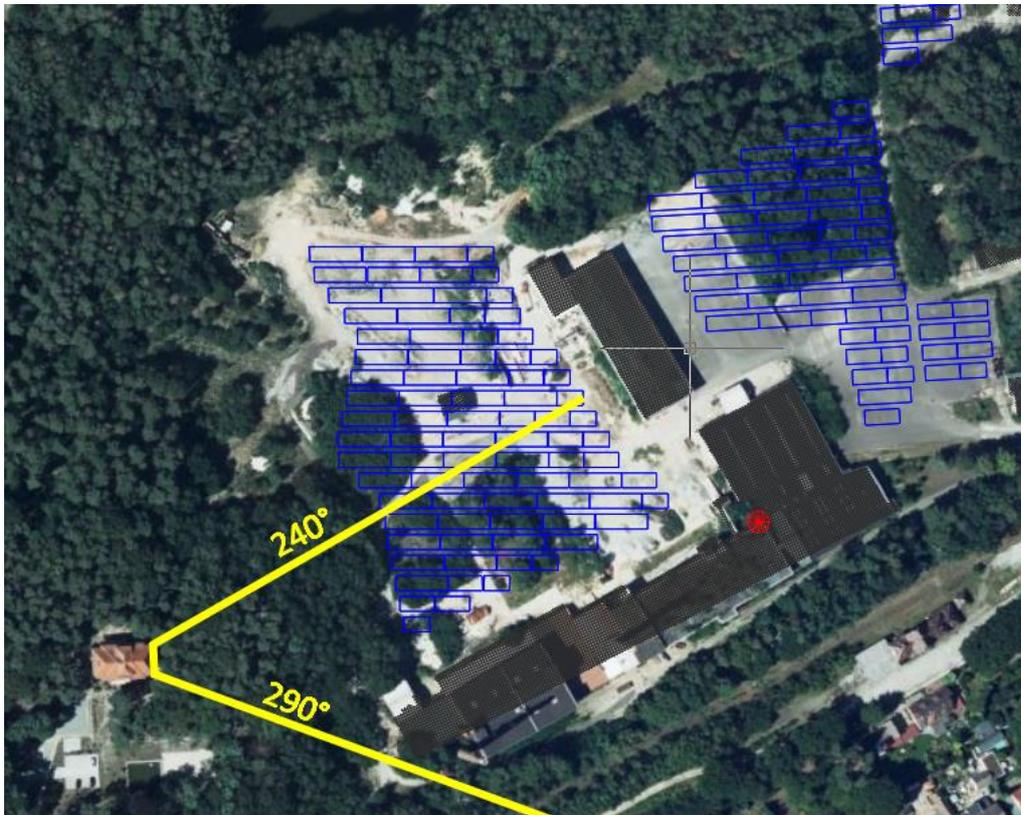
Abbildung 10: Azimutbereich westlich zur Behindertenwohnstätte gerichteter Reflexionen mit Winkeln zwischen  $240^\circ$  und  $290^\circ$  durch gelbe Linien abgegrenzt
