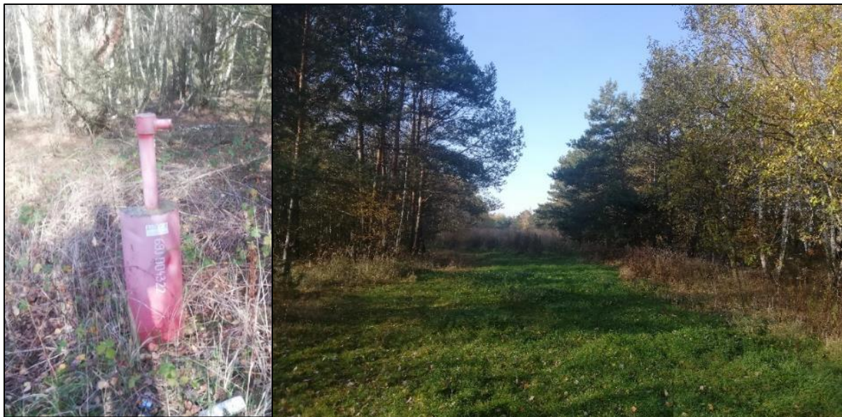
Abb. 3: Aktiver GW-Messbrunnen (links) und ehemalige Filterbrunnenstrecken (rechts)
